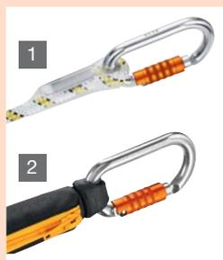
Die Endverbindungen der Petzl-Verbindungsmittel sind entsprechend den Modellen mit Kunststoffüberzügen (Bild 1) oder STRING-Elementen (Bild 2) versehen. Sie sorgen dafür, dass das Verbindungselement in der Längsachse belastet wird und erleichtern das Einhängen. Zudem schützen sie die Endverbindungen vor Abnutzung durch wiederholtes Scheuern.
