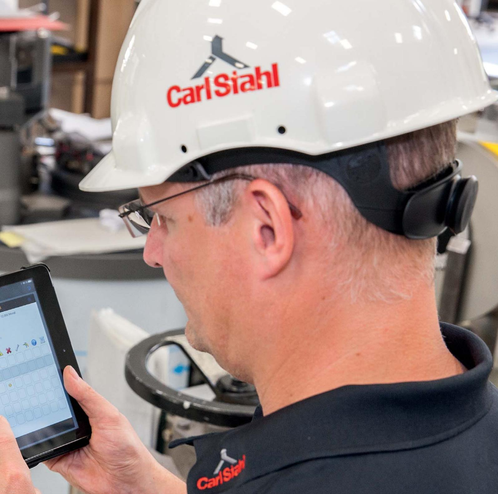
Auslesen der Daten eines Transponders an einem Verbindungsmittel
