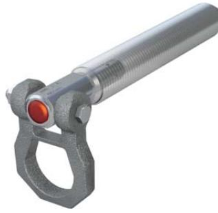
Das System basiert auf 2 Elementen. Der ABS-Lock® I ist ein abnehmbarer Anschlagpunkt, der mit Knopfdruck eingesetzt und ebenso unkompliziert wieder abgenommen wird. Sobald die Sperrkugeln des Anschlagpunkts arretieren, hält er problemlos Belastungen von 2 Tonnen und mehr stand. Er eignet sich damit bestens zur Fensterabsturzicherung.
