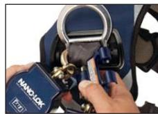
Nasenende des Karabiners hinter die gelockerte Schlaufe unterhalb der hinteren Auffangöse (D-Ring) schieben und zweites HSG befestigen.
