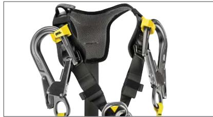
Jeder Schulterträger verfügt über ein Verstauesystem für die MGO-Verbindungselemente der Verbindungsmittel zur Absturzsicherung. So kann das Verbindungsmittel den Anwender nicht stören und die Verbindungselemente sind stets griffbereit. Im Falle eines Sturzes ermöglicht dieses System das Aufreißen des Falldämpfers durch Freigabe der MGO.
