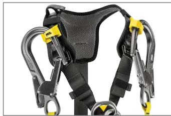
Jeder Schulterträger verfügt über ein Verstauesystem für die MGO-Verbindungselemente der Verbindungsmittel zur Absturzsicherung. So kann das Verbindungsmittel den Anwender nicht stören und die Verbindungselemente sind stets griffbereit. Im Falle eines Sturzes ermöglicht dieses System das Aufreißen des Falldämpfers durch Freigabe der MGO.
