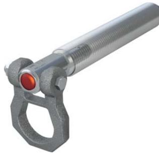
Das System basiert auf 2 Elementen. Der ABS-Lock® I ist ein abnehmbarer Anschlagpunkt, der mit Knopfdruck eingesetzt und ebenso unkompliziert wieder abgenommen wird. Sobald die Sperrkugeln des Anschlagpunkts arretieren, hält er problemlos Belastungen von 2 Tonnen und mehr stand. Er eignet sich damit bestens zur Fensterabsturzicherung.
