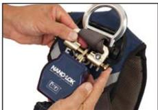
Sicherungsbolzen wieder einsetzen und durch Wirbelauge am HSG schieben. Ein-drücken, bis der Bolzen einrastet.
